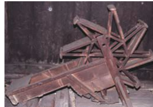
ふみ車 (田より低い堰 (せき) から水を揚げる)
