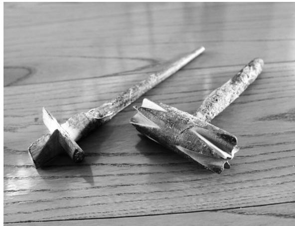
写真16 イタヤカエデ製の蔓を裂くための道具
