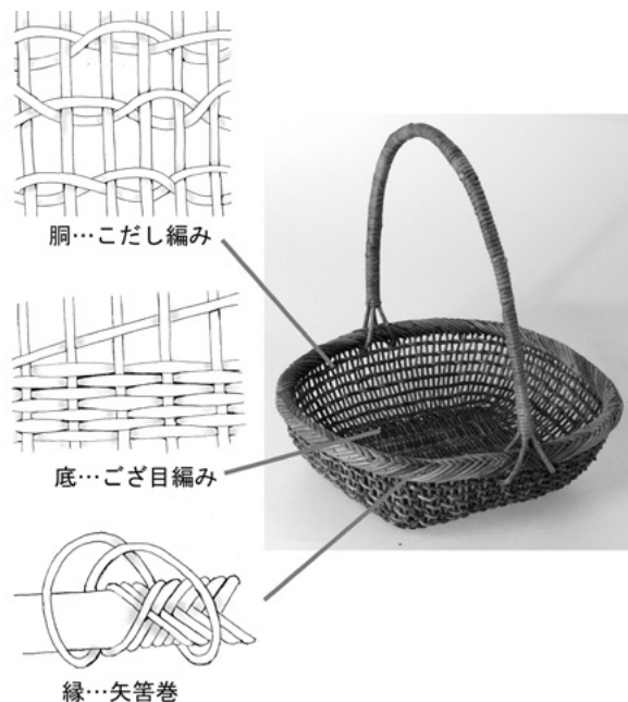
図2 あけびづる細工 各部分の編み方
