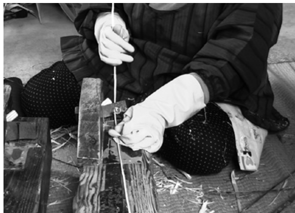
写真8 横ひごの仕上げこぎ(道具③を使う) 道具③は穴の形が三角になっており、一気に両方の角が落ちるようになっている。
