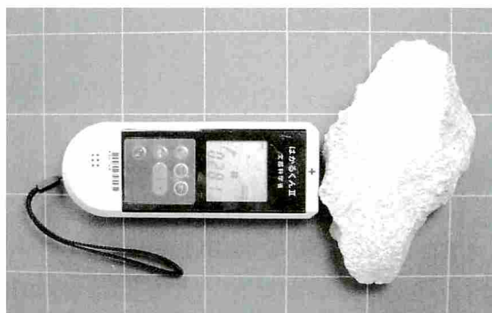
写真5 線量計「はかるくんII」による測定
