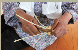
②専用の道具で蔓を4〜6分割に割っていく。道具はイタヤカエデで作られている。
